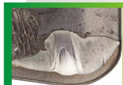
前刀面磨损 (月牙洼磨损)
