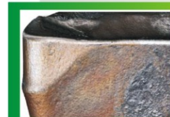
部分削落 陶瓷刀片
